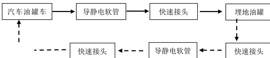
注：虚线箭头表示油气回收工艺路线。
